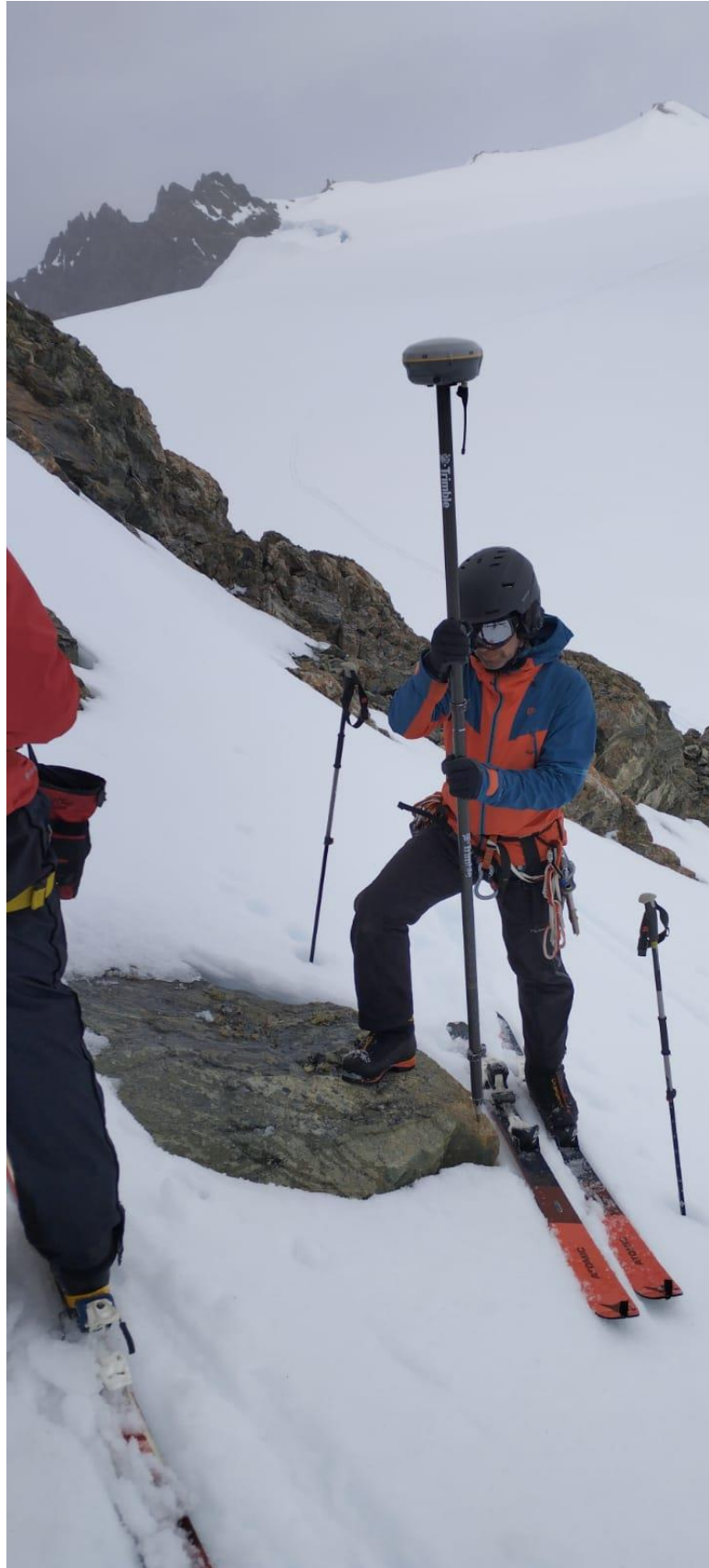
Figura 2: Toma de punto de control GNSS para georreferenciación de imágenes ópticas de satélite.
