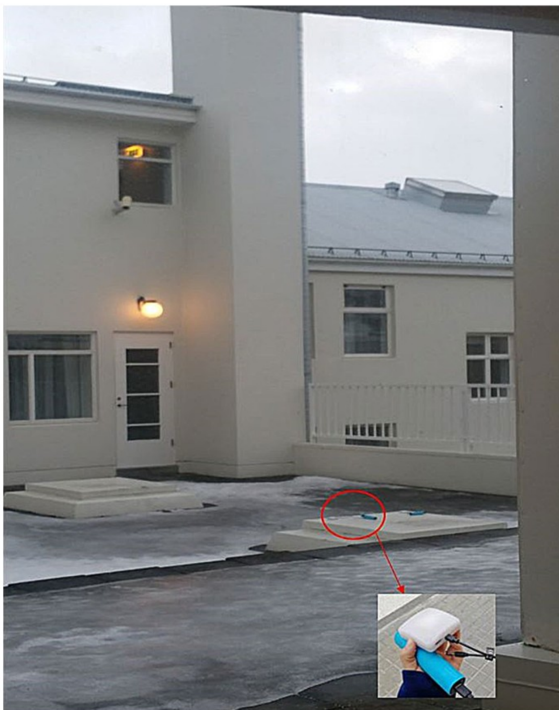
Figura 2: Ubicación del receptor GNSS de bajo coste y frecuencia única, Argonaut, en un entorno urbano y de centelleo cerca del círculo polar ártico (Akureyri, Islandia), durante el experimento correspondiente, el 19 de diciembre de 2017.
