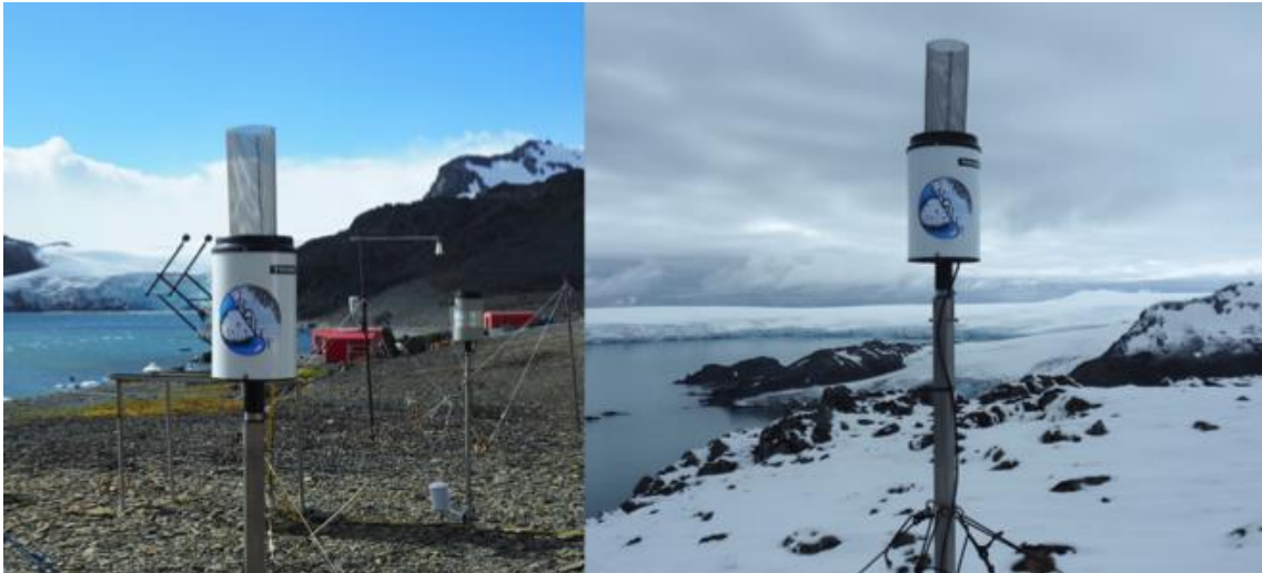
Figura 1: Pluviómetros del proyecto DROPLET para cuantificación de precipitación oculta, instalados a nivel del mar y a 275m de altitud en las proximidades de la Base Antártica Española Juan Carlos I (Isla Livingston, Antártida) con la inestimable ayuda de los equipos UTM-CSIC y AEMET-Antártida.
