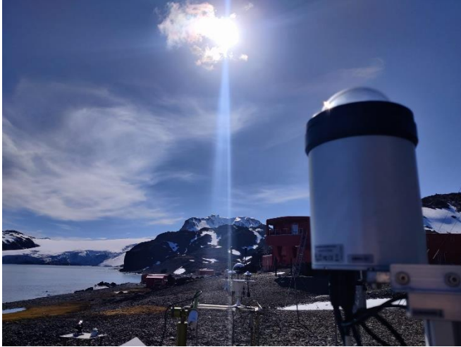
Figura 1: Cámara de todo cielo instalada en la BAE Juan Carlos I durante la campaña 22-23.
