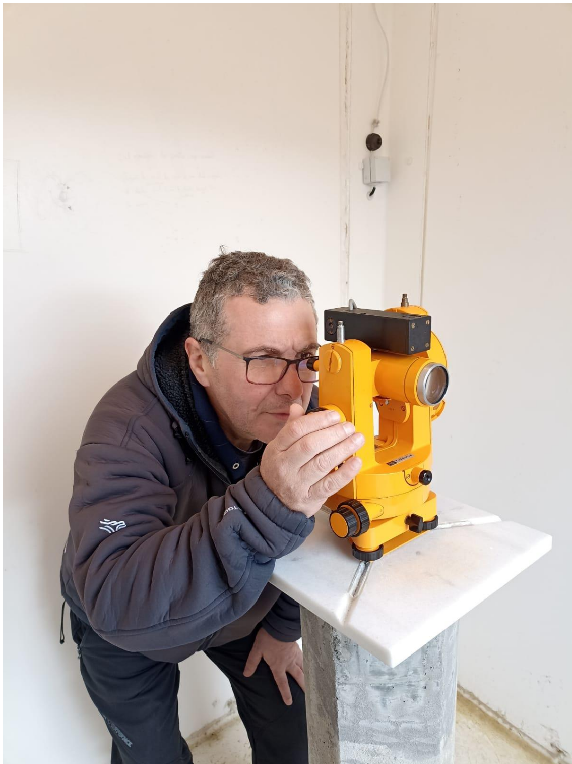
Figura 2: Realizando observaciones geomagnéticas absolutas mediante un magnetómetro DIFLUX.
