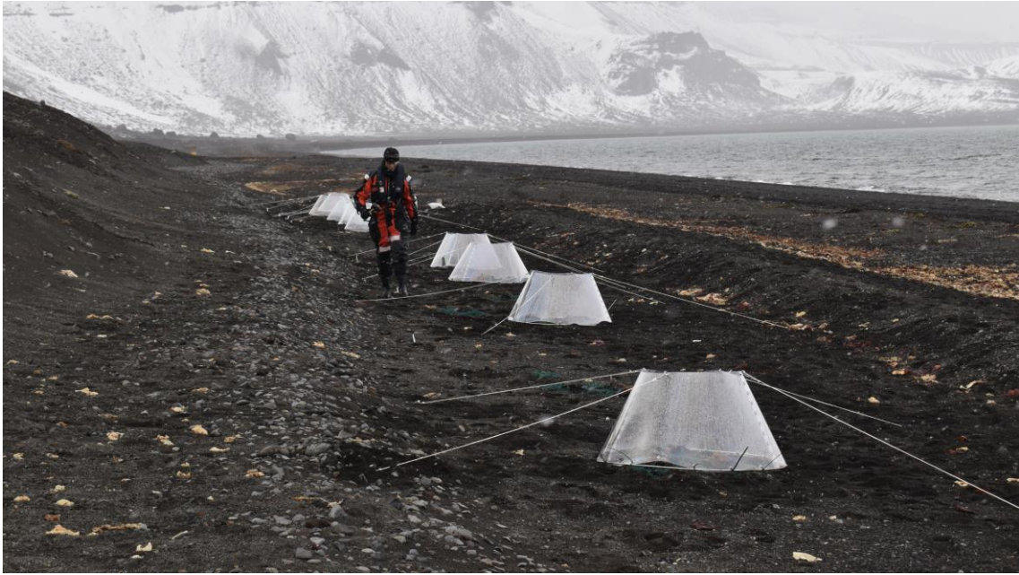
Imagen 1: Disposición de las cámaras de calentamiento por efecto invernadero en la playa de Fumarolas.
