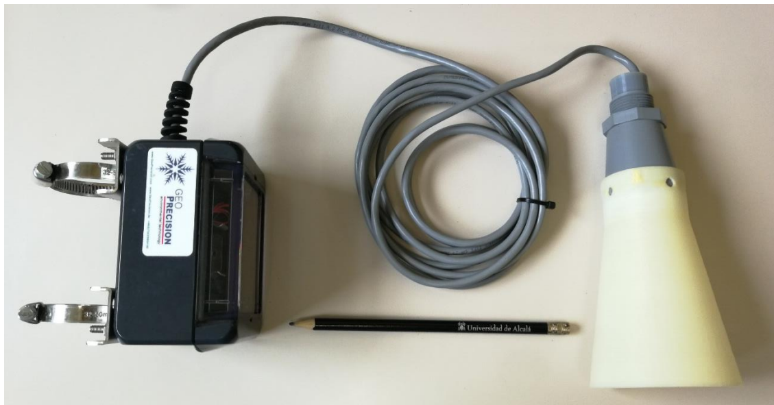
Figura 2: Ejemplo de uno de los dispositivos para la medida del espesor de nieve que se instalarán durante la campaña 2023-24, completándose así la renovación de la instrumentación de la red PERMATHERMAL.
