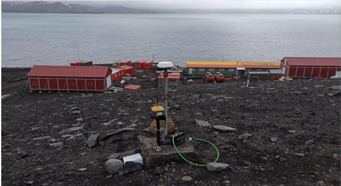
Figura 1: Registro simultáneo GNSS GALILEO PRS y GNSS GPS en un vértice de coordenadas conocidas
