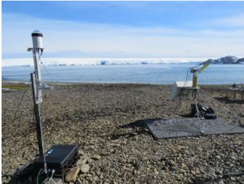
Figura 1: Cámara de todo cielo y radiómetro CIMEL instalados en la BAE Juan Carlos I desde la Campaña Antártica 2022-2023.
