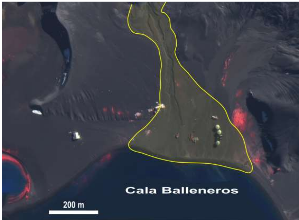
Figura 2: Restos de la Base B británica en isla Decepción destruidos en 1969 por un flujo de barro y derrubios ( lahar ) que se señala con un contorno amarillo. Ortoimagen en falso color obtenida a partir de escenas satelitales PLEYADES del 23 febrero de 2024 (cortesía de AIRBUS DS) reconstruidas estereoscópicamente. Color rojo indica la incipiente vegetación o tapices de algas.
