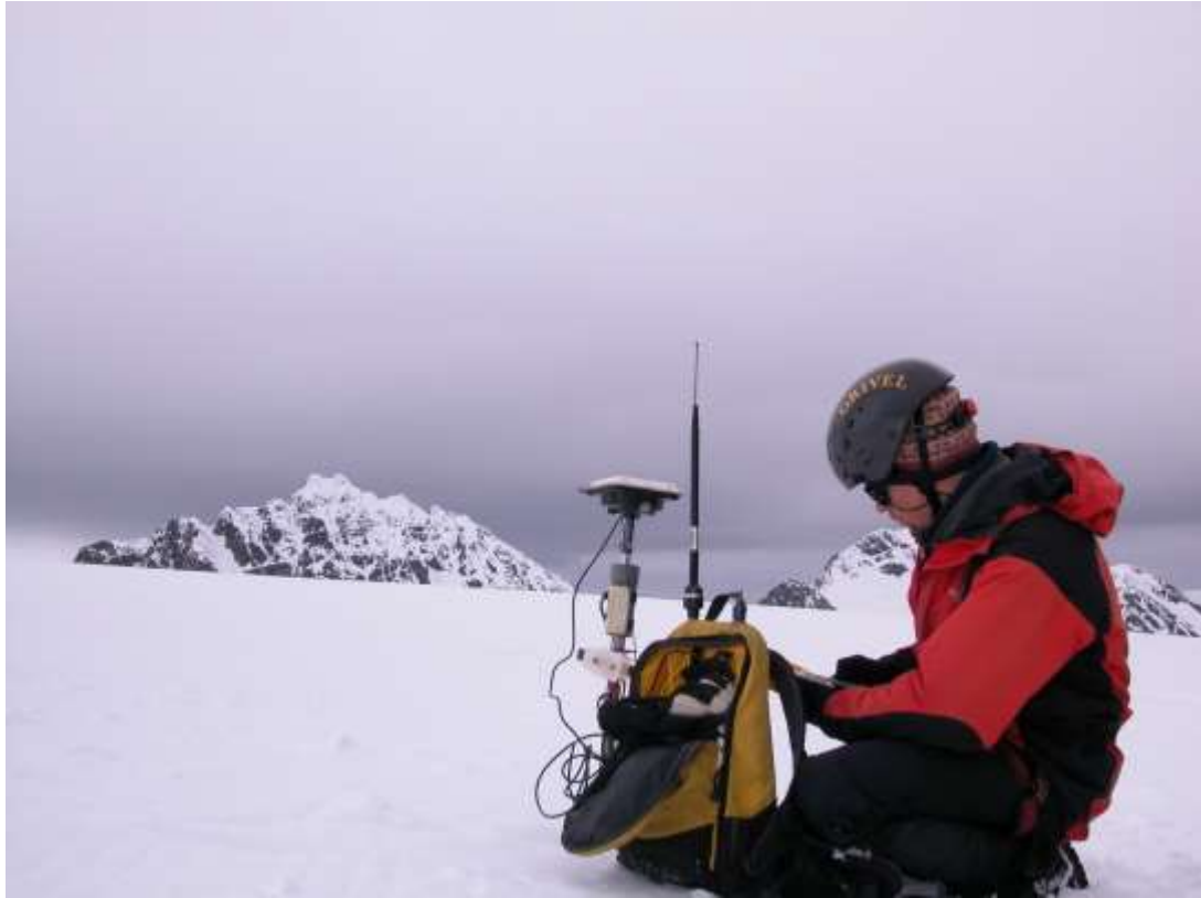
Figura 1: Medida de posicionamiento GNSS de una estaca de velocidad y acumulación-ablación.
