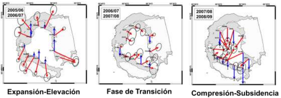
Figura 1: Mecanismo geodinámico de carácter volcánico en la isla Decepción obtenido mediante la continuidad de modelos GNSS 3d obtenidos desde la campaña 1999-2000 hasta la actualidad. Se ilustra como ejemplo, las fases obtenidas entre las campañas 2005-06 y 2008-09.
