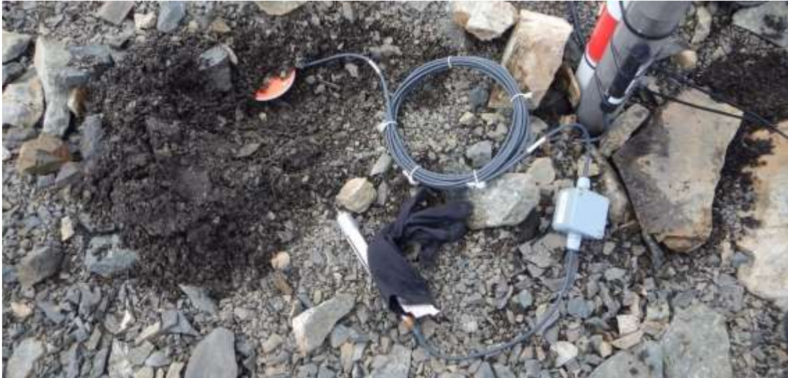
Figura 1: Ejemplo los sensores de flujo térmico que se instalarán en las estaciones de la red PERMATHERMAL durante la campaña Antártica 2025-26, completando así la instrumentación de las mismas.
