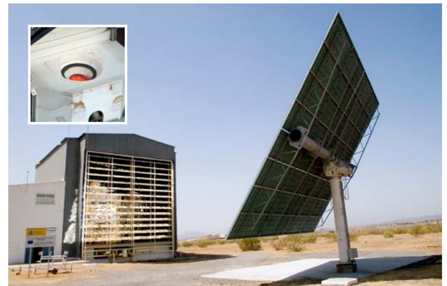
En recuadro pequeño, lecho fluidizado rojo después de la prueba solar de reducción de regolito lunar.
